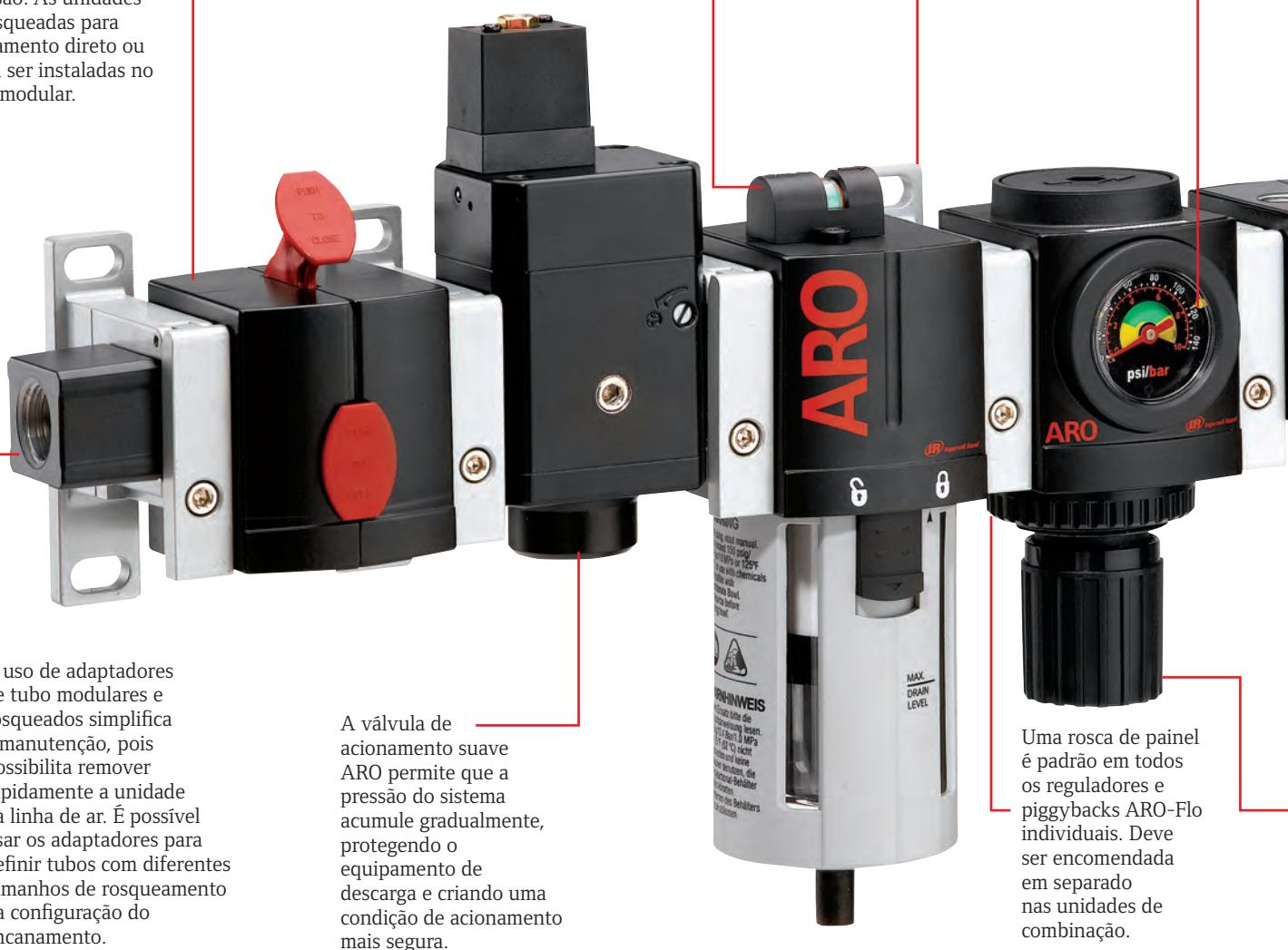
O uso de adaptadores de tubo modulares e rosqueados simplifica a manutenção, pois possibilita remover rapidamente a unidade da linha de ar. É possível usar os adaptadores para definir tubos com diferentes tamanhos de rosqueamento na configuração do encanamento.
