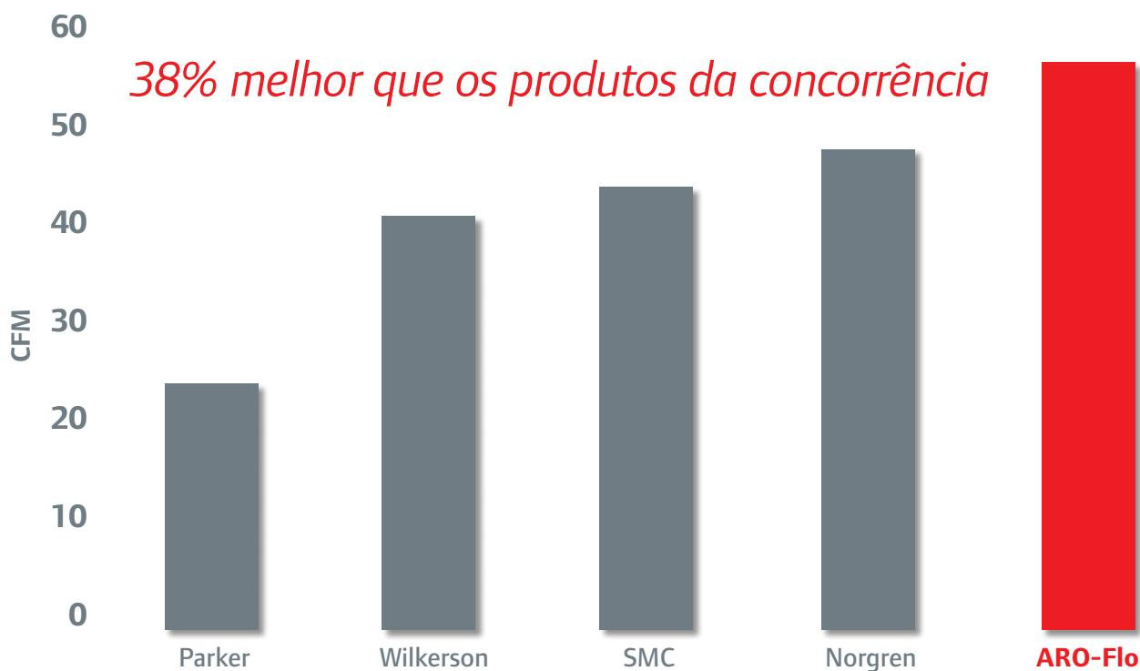
Parâmetros de teste: Pressão de entrada de 100 psi, pressão de ajuste de 90 psi e queda de 33 psi
